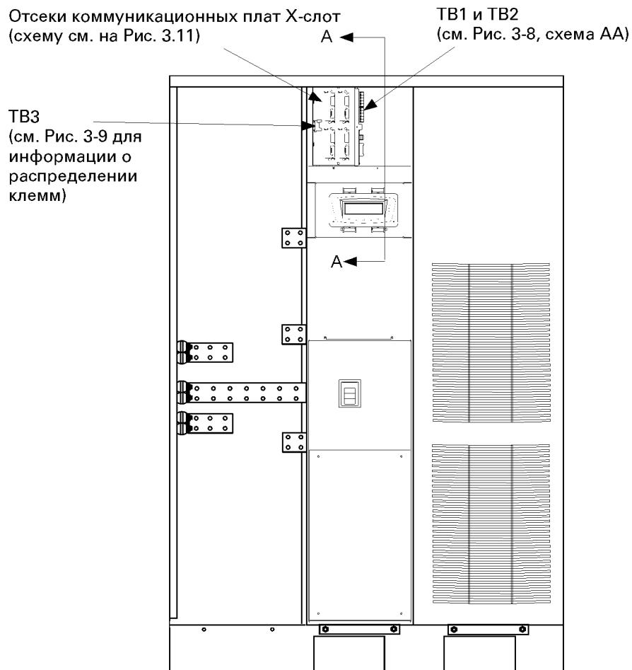
**Рис. 3-7. Расположение клемм для подключения внешних устройств**
