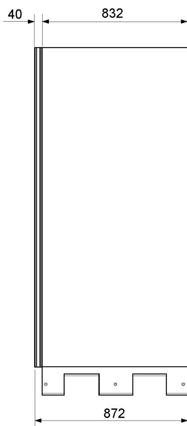
**Рис. 2-2. Размеры ИБП (вид справа)**
