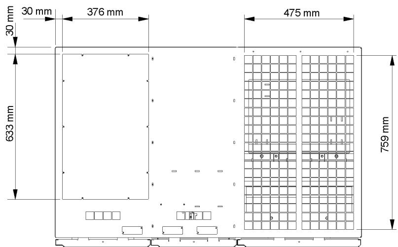
**Рис. 2-3. Размеры ИБП (вид сверху)**
