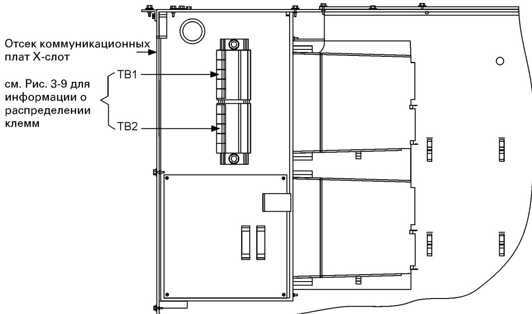
**Рис. 3-8. Схема клемм подключения внешних устройств АА**
