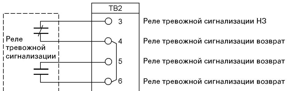
**ПРИМЕЧАНИЕ** Максимальный ток релейных контактов составляет 5А, напряжение переключения 30 В переменного тока и 28 В постоянного тока.
