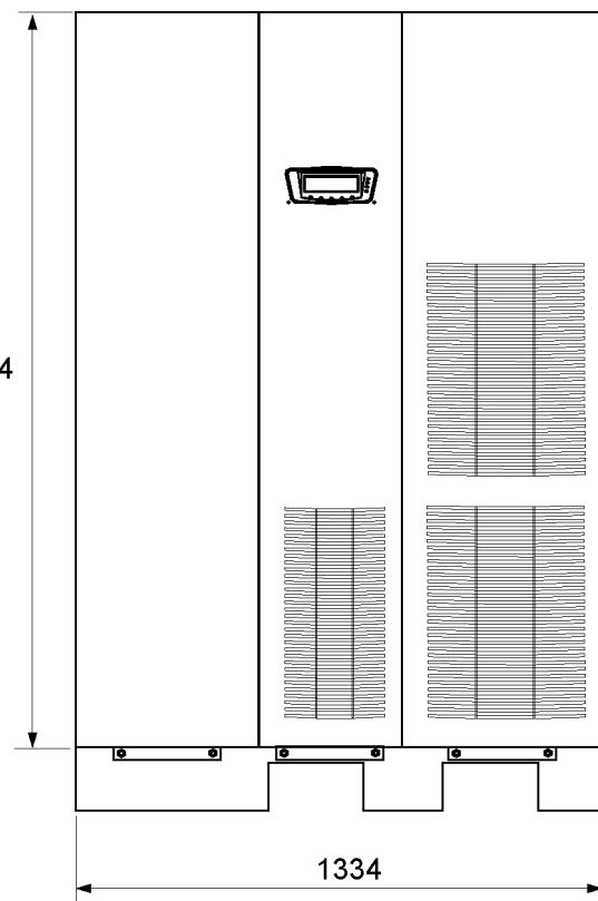
**Рис. 2-1. Размеры ИБП (вид спереди)**
