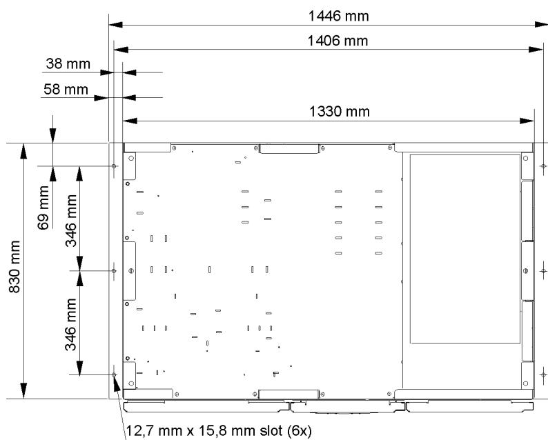
**Рис. 2-5. Размеры ИБП (вид снизу с монтажными кронштейнами)**
