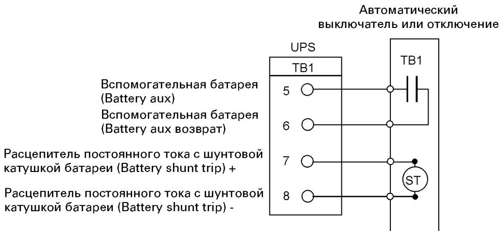
**ПРИМЕЧАНИЕ** Сечение кабелей Battery Aux и Shunt trip должно быть не менее 1,5 мм<sup>2</sup>.
