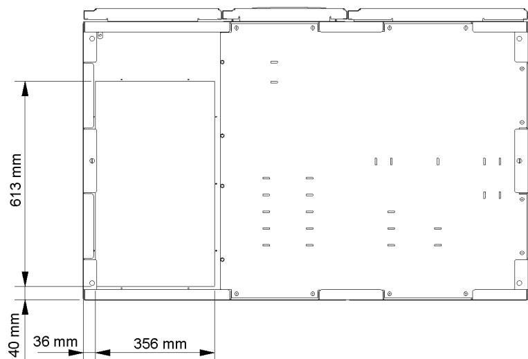
**Рис. 2-4. Размеры ИБП (вид снизу)**
