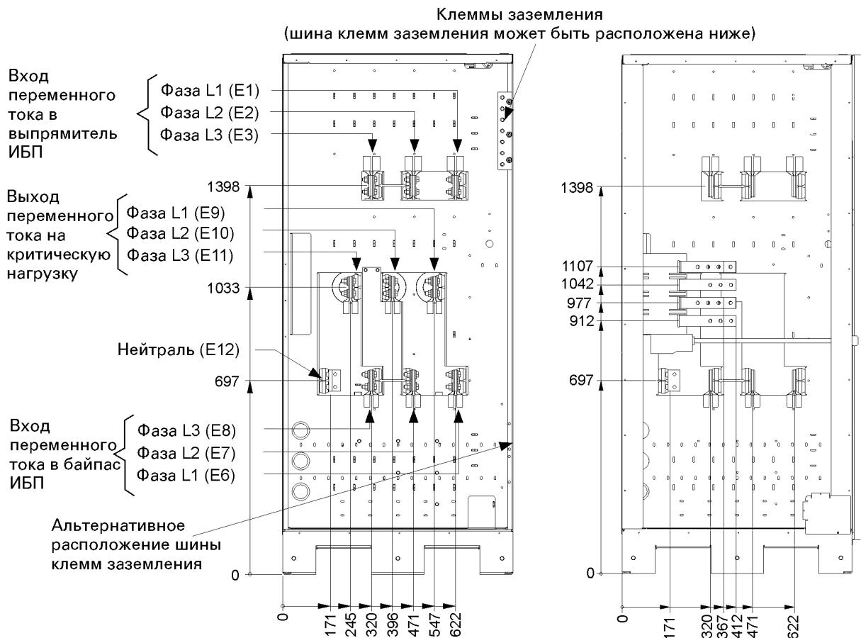
**Рис. 3-5. Силовые выводы ИБП, схема АА**
