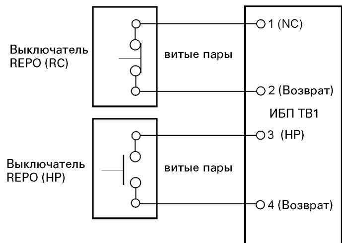
**Примечание** Минимальные напряжения и ток выключателя дистанционного аварийного отключения 24 Вольт постоянного тока и 1 А.
