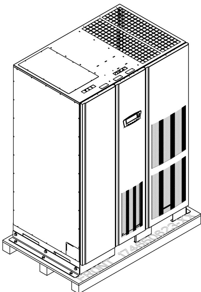
**Рис. 2-8. Шкаф ИБП Powerware 9395 (225–275 кВА) при транспортировке на поддоне**
