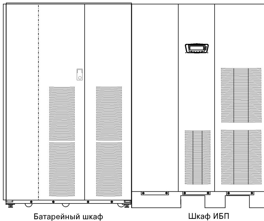
Рис. 1-2. Стандартная система ИБП Powerware 9395 (225–275 кВА)
